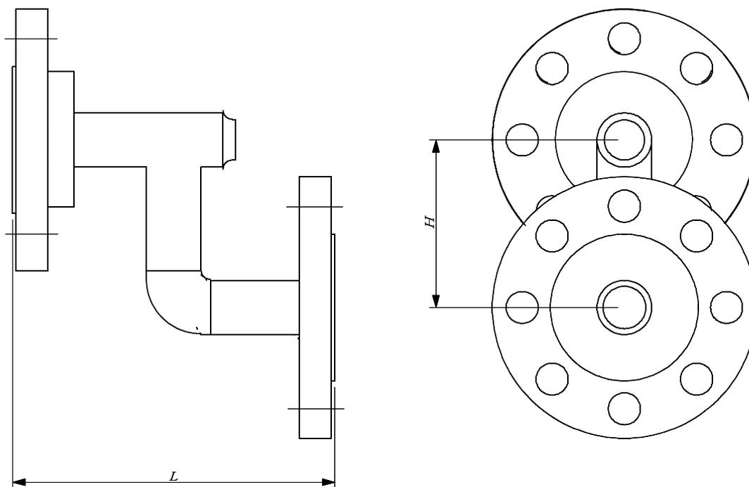
入口フランジと出口フランジの上下が逆配置の形状も提供できます。
